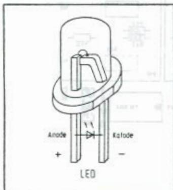
d.h. Die LED's der Ein- und Ausgängen mit Bit 0,1,2,3 (siehe Weißdruck) werden mit der Kathode rechts bestückt, alle LED's mit Beschriftung Bit 4,5,6,7 mit Kathode links.
