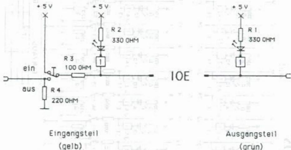
Es wurde schon erwähnt, daß im Eingangsteil (gelb) die Priorität auf die Schalter gegenüber den Buchsen gelegt wurde. d.h. ist der Umschalter in oberer Stellung, gelangt die Spannung 5V über R3 an die IOE (zum Z 80) und über den Inverter an die jeweilige LED. Dabei ist der Spannungspegel an der Buchse ohne Bedeutung.
